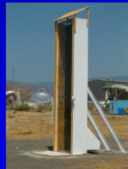
Prototipo de chimenea solar
